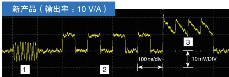
通过将示波器的电压灵敏度设为1/10,提高示波器自身的S/N比,从而观测到漂亮的波形。
